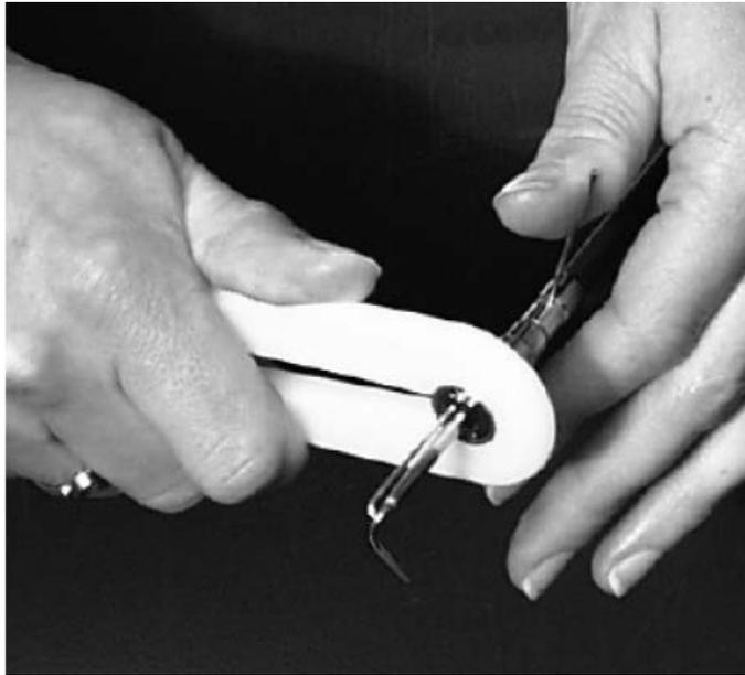
Figure 8 Remplacement d'une tige de ferrite
