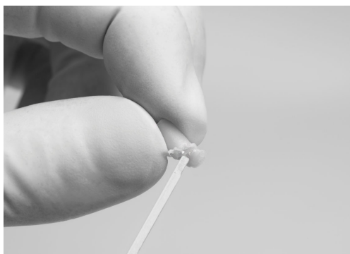
Figure 85 - Le matériau non polymérisé est retiré du bouchon d'essai composite
