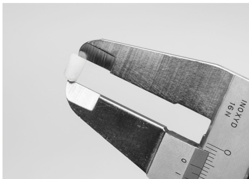
Figure 86 - Mesure de la profondeur du bouchon d'essai
