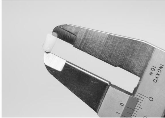
**Figura 6 – Misurazione della profondità del tappo di prova**
