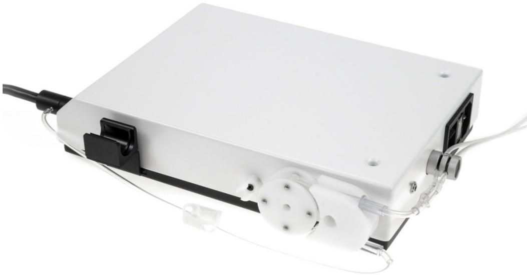
Abbildung 6 Schlauchset befestigt
