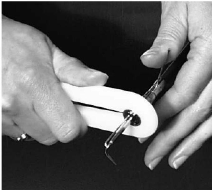
Abbildung 8 Austausch des Ferritstabs
