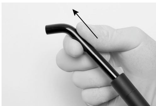
Figura 72 – Rimuovere il puntale della lampada dal manipolo XO ODONTOCURE
