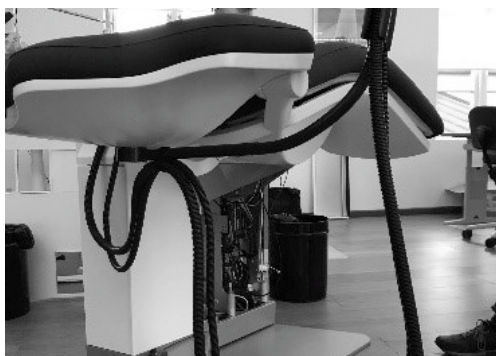
Figure 54 – Fissaggio dei tubi al supporto Ambidex
