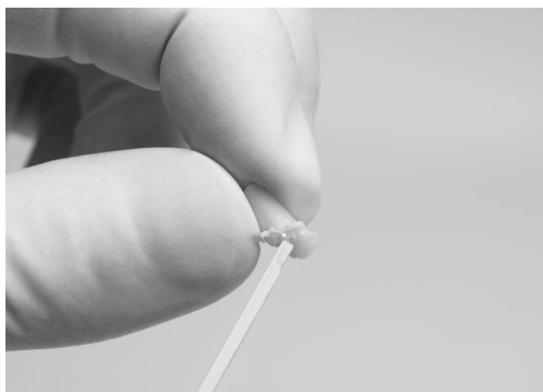
Figura 85 – Materiale non polimerizzato rimosso dal tappo di prova del composito
