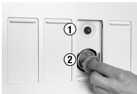
Figura 89 – Attivazione manuale della valvola della sputacchiera (1) e filtro della valvola della sputacchiera (2)
