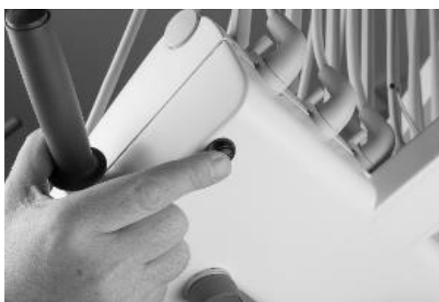
Figura 38 – Avvio della selezione dello strumento da usare con XO Peristaltic Pump
