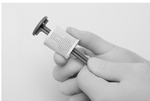
Figura 79 – Rimozione della cartuccia del filtro dal supporto
