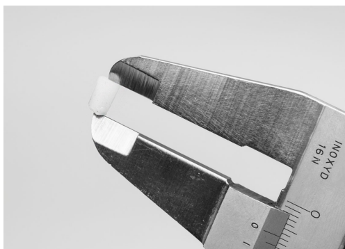
Figura 86 – Misurazione della profondità del tappo di prova
