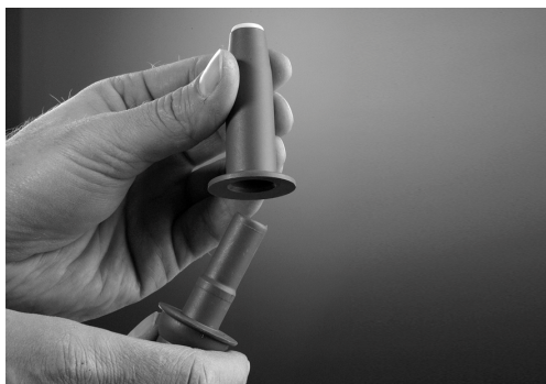
Figura 75 – Rimozione dei cappucci dai terminali dei tubi
