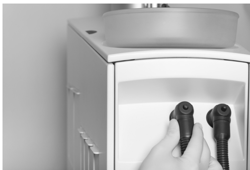
Figura 77 – Rimozione dei tubi di aspirazione e dei filtri
