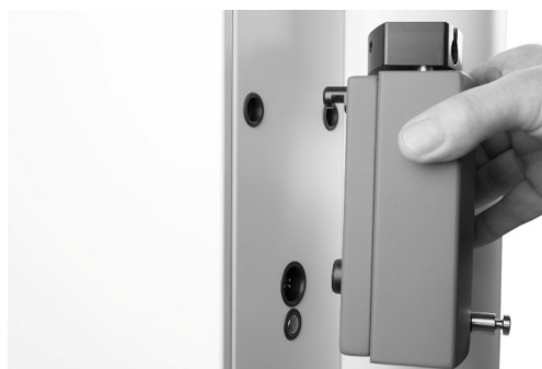
Figura 29 – Attacco del modulo della pompa al riunito
