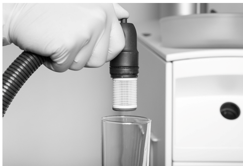
Abbildung 78 - Drücken Sie die Taste, um den Filter auszuwerfen.
