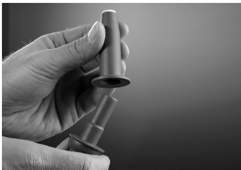
Figur 75 – Fjernelse af yderkappe på sugeslange dyse
