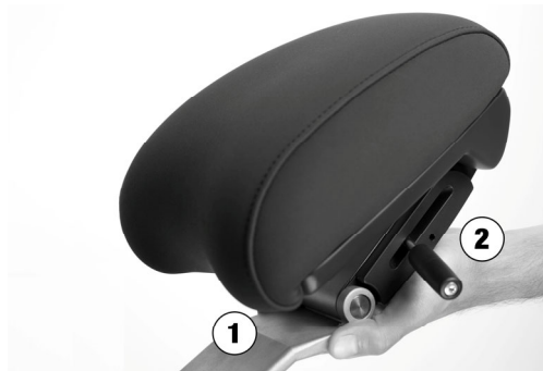
Figur 10 – Nakkestøtte: Træk / skub med (1) mens stolen kører og lås med (2) håndtag til friktions lås
