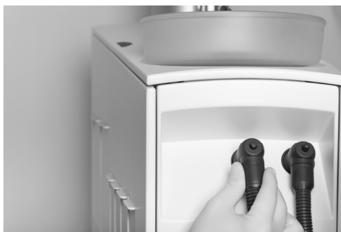
Figur 77 – Fjernelse af sugeslanger og filtre
