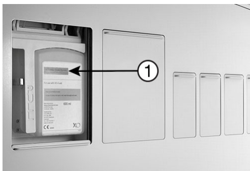
Figur 81 – Udskiftning af XO Water Disinfection beholder
